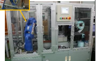
▼右から、ラベル発行機、画像認証機、多軸ロボット。3点セットは業界初。
