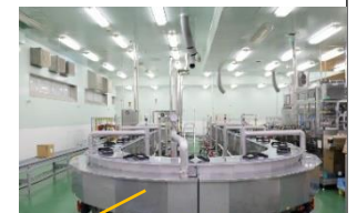
▲省スペースを実現した業界初のUターン型冷却層。回転する水流の力のみで搬送される。
