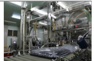
▲BIB(ピロー型タイプ)への充填。X線での検査通過後、ドライ製品はそのまま箱へ、冷却製品は冷却層へ向かう。
